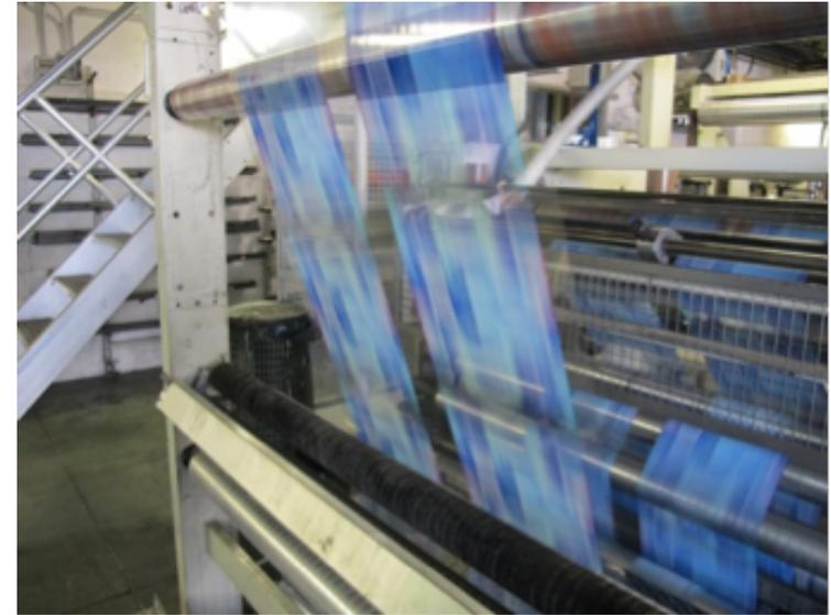
**Assenza barra antistatica prevista dal manuale della macchina: elevato campo elettrostatico IN PROSSIMITA' ROTOLI PLASTICA. RISCHIO innescò di incendi - RISCHIO PER PORTATORI PACEMAKER E DISPOSITIVI IMPIANTATI**
