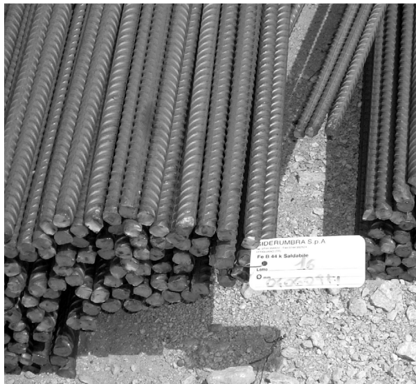
Fig. 6.43 - Fascio di tondini in ferro per le armature delle strutture in c.a. Si noti in sigillo con il marchio indicante la fabbrica e il lotto di produzione.
