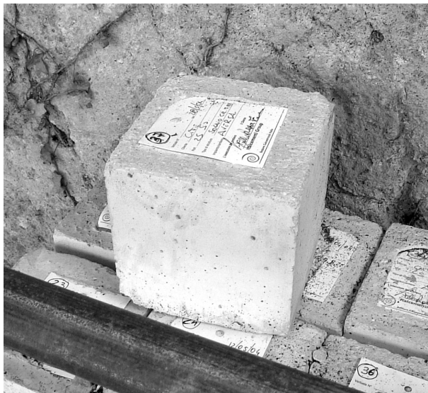
Fig. 6.42 - Provino di calcestruzzo pronto per essere inviato al laboratorio di prova. Si noti la targhetta identificativa del provino.
