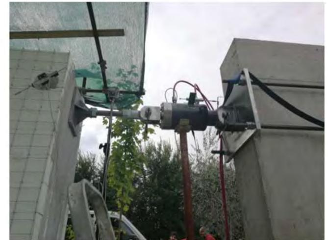
Figura 4.14. Sistema di applicazione del carico per prove cicliche quasi statiche.
