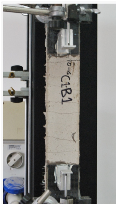
vista delle fessure in stadio
